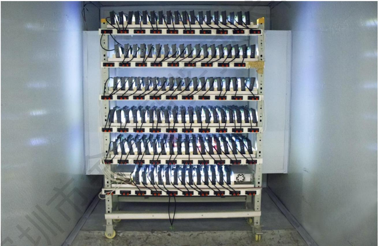
测试环境:高低温老化测试箱中
